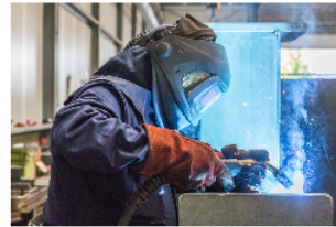
Lasser die overdrukhelm met aangedreven filter gebruikt
